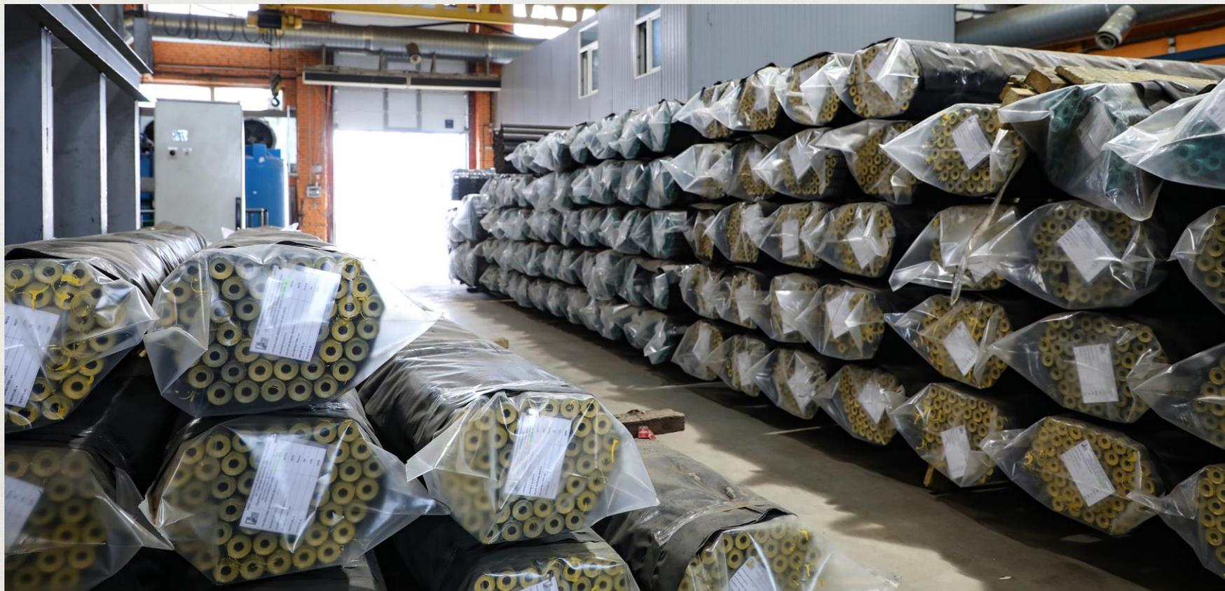
Производится 17 типоразмеров МГТС «GEOIZOL-MP» (диаметры от 30 мм до 135 мм) в двух исполнениях – обычном и высокопрочном, с рабочими нагрузками в диапазоне от 139 до 5 571кН.
