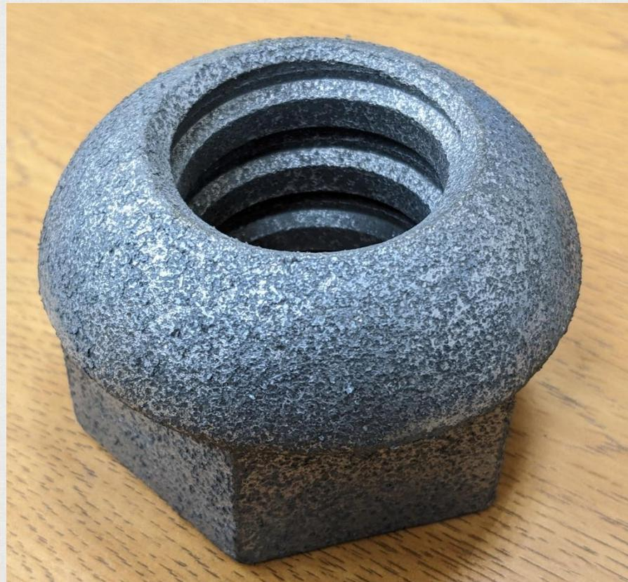
Дуплекс-система подразумевает совмещение термодиффузионное цинкование с последующей порошковой покраской. Образуется защитный слой 120-130 мк.
