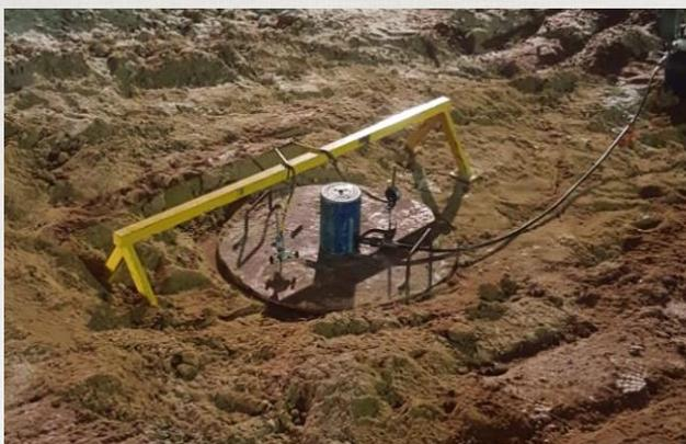
2. Выполнение статического зондирования и штамповых испытаний после завершения работ. Испытания фиксируют параметры массива модифицированного грунта.
