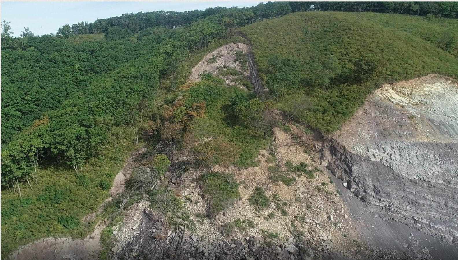
**Оползень** — смещение масс горных пород по склону под воздействием собственного веса, приложения дополнительной нагрузки, изменения рельефа и иных природных или техногенных факторов.
