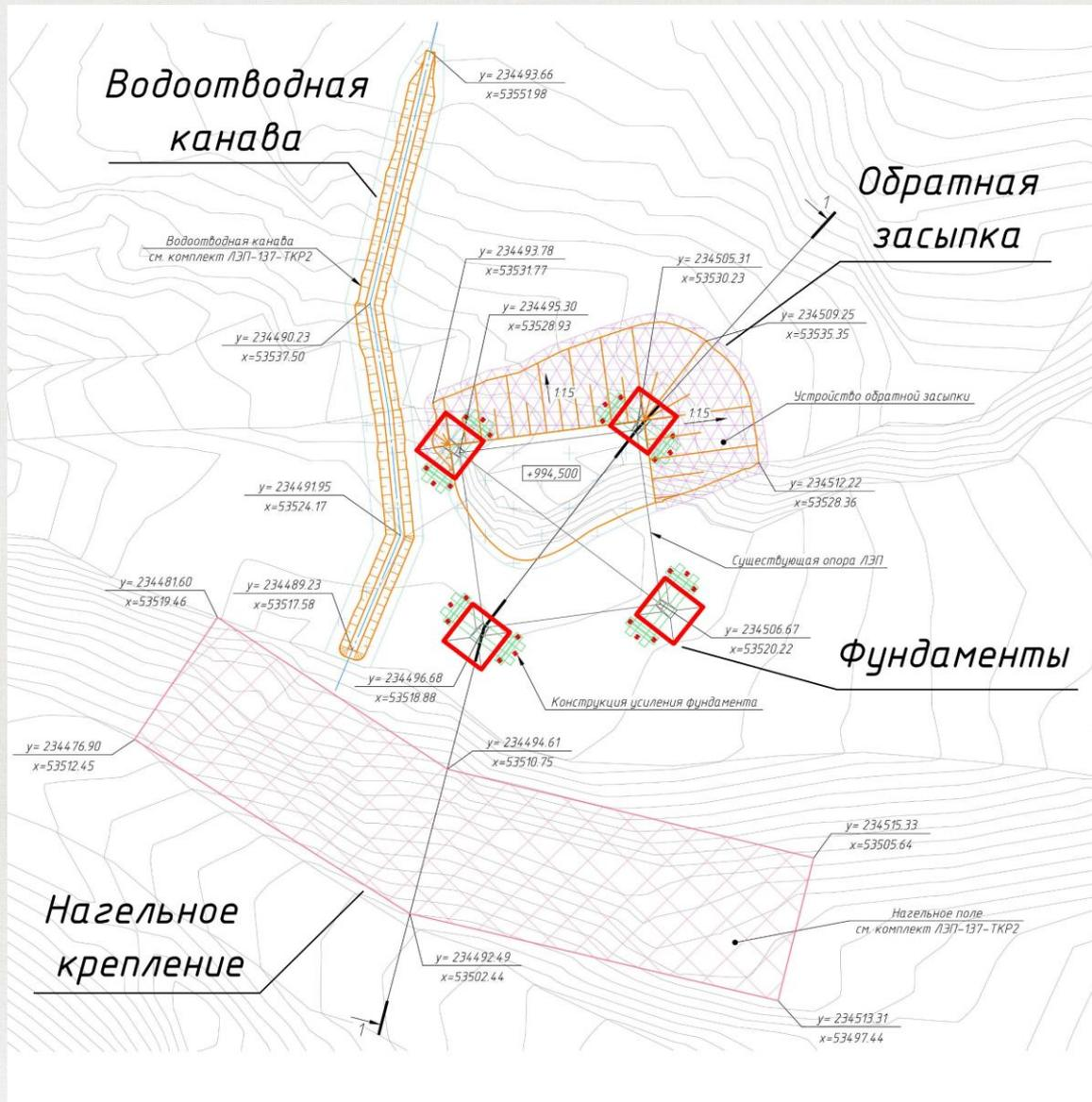
Проект включает выполнение противоэрозийной защиты на участках вскрытых грунтов и устройство системы водоотведения.
