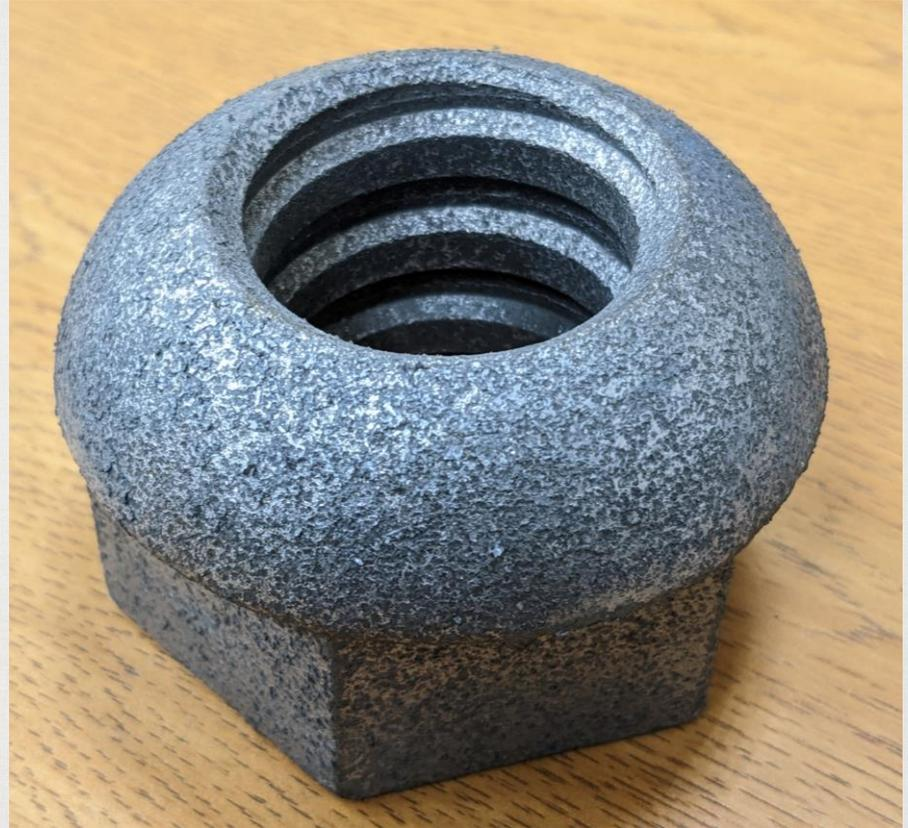
Совмещение термодиффузионное цинкование с последующей порошковой покраской. Образуется защитный слой 120-130 мк.
