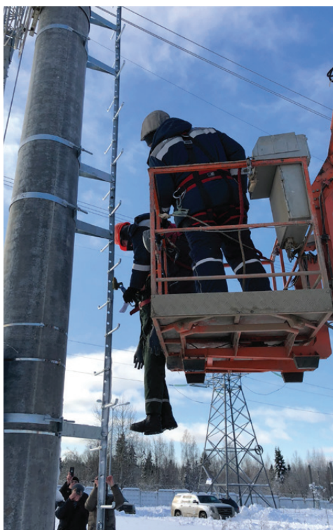
Рис. 4, 5, 6, 7. Испытания Т-образной жесткой анкерной линии и устройств ползункового типа при температуре -20^{\circ}\text{C} . ЦПП «Белый Раст» - ПАО «ФСК ЕЭС»
