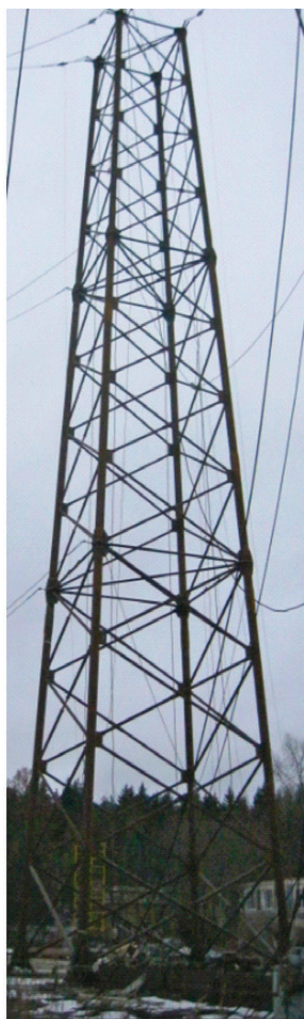
Рис. 11. Испытание промежуточной опоры АВУМ-110-60/80 и анкерно — угловой опоры АВУР-110-60/80 для ВЛ 110 кВ
