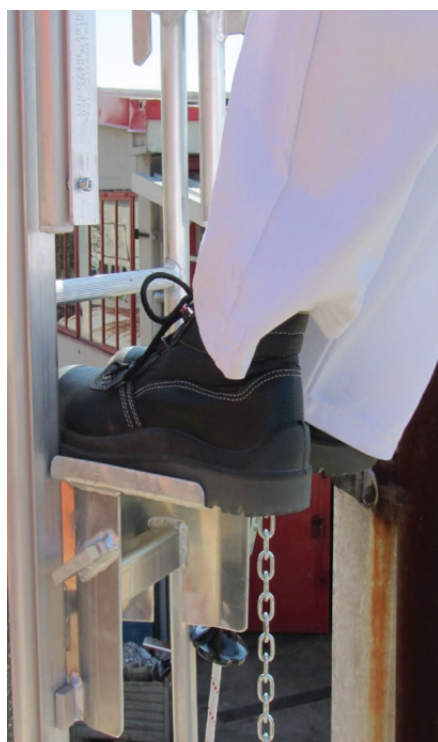
Рис. 13, 14. Платформа для одного электромонтера с возможностью установки на ступенях лестницы Модель 2142ASL
