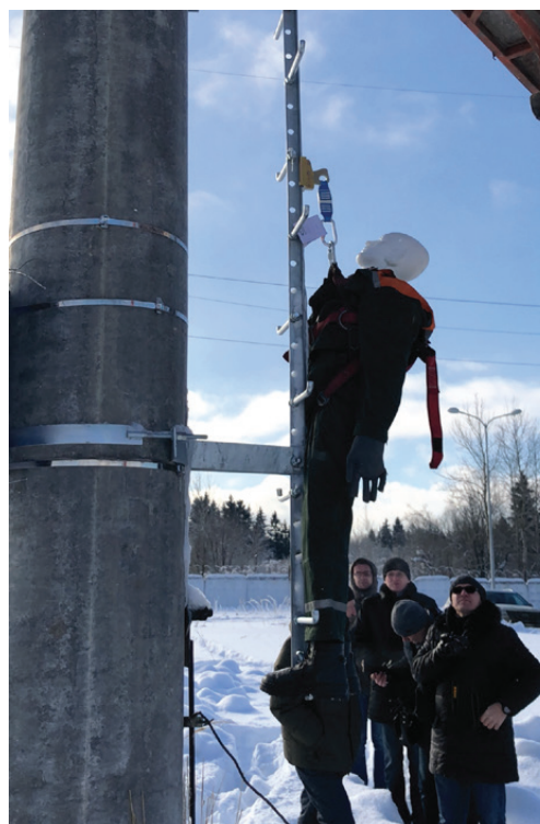
Рис. 4, 5, 6, 7. Испытания Т-образной жесткой анкерной линии и устройств ползункового типа при температуре -20^{\circ}\text{C} . ЦПП «Белый Раст» - ПАО «ФСК ЕЭС»
