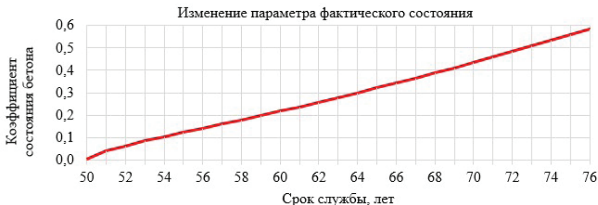
Рис. 1. График изменения параметра фактического состояния железобетонных опор Л-2540 до прогнозируемого предельного состояния.
