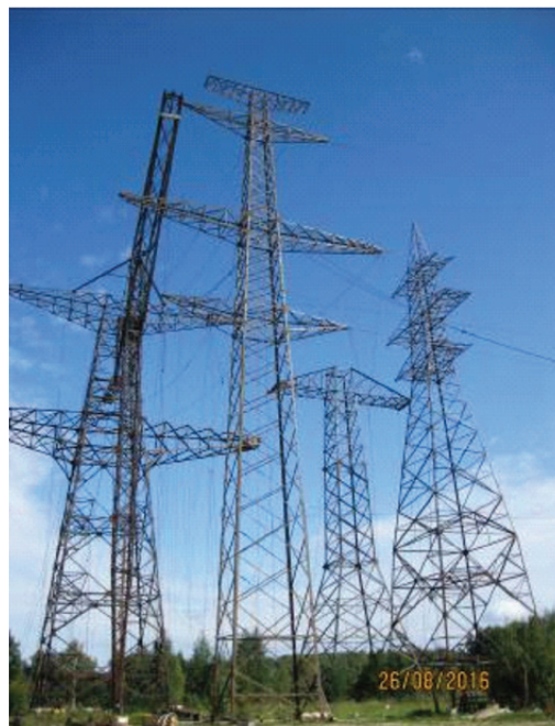
Рис. 10. Испытание двухцепных анкерной угловой стальной решетчатой опоры типа УС500-2/14 и промежуточной стальной решетчатой опоры типа ПС500-2/28,5
