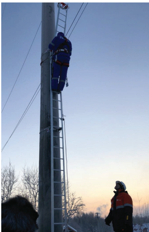
Рис. 4, 5, 6, 7. Испытания Т-образной жесткой анкерной линии и устройств ползункового типа при температуре -20°С. ЦПП «Белый Раст» - ПАО «ФСК ЕЭС»
