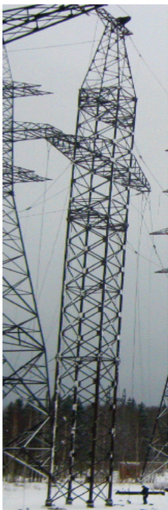
Рис. 11. Испытание промежуточной опоры АВУМ-110-60/80 и анкерно — угловой опоры АВУР-110-60/80 для ВЛ 110 кВ
