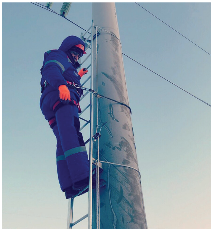
Рис. 4, 5, 6, 7. Испытания Т-образной жесткой анкерной линии и устройств ползункового типа при температуре -20°С. ЦПП «Белый Раст» - ПАО «ФСК ЕЭС»
