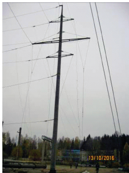
Рис. 14. Испытание одноцепной и двухцепной промежуточных железобетонных секционированных опор СПБ110-3П и СПБ110-4П.
