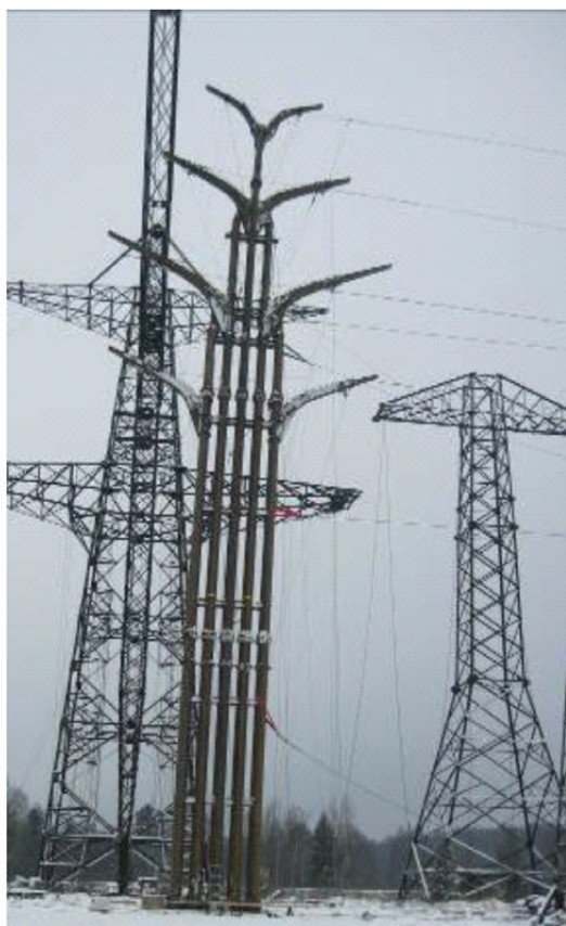
Рис. 9. Испытание двухцепной анкерно - угловой многогранной опоры типа АУМ220-2т/25,3.
