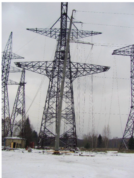
Рис. 14. Испытание одноцепной и двухцепной промежуточных железобетонных секционированных опор СПБ110-3П и СПБ110-4П.
