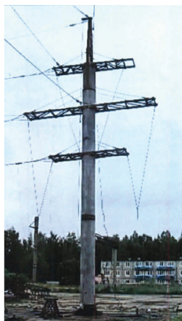
Рис. 15. Испытание одноцепной и двухцепной анкерно — угловых железобетонных секционированных опор СУБ110-1Ф и СУБ110-2Ф
