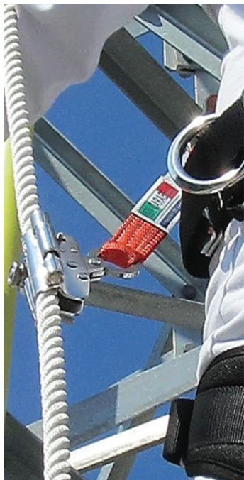
Рис. 25. Устройство ползункового типа АРТ. 3408CENTP с гибкой анкерной линией АРТ. А08Р14L
