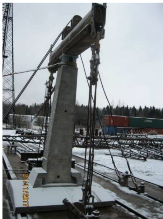
Рис. 1. Испытания фундаментов ФМ3-32.20.20-1Ш и ФМ4-32.20.20-1Б (Ф1 и Ф2) на сжимающие нагрузки
