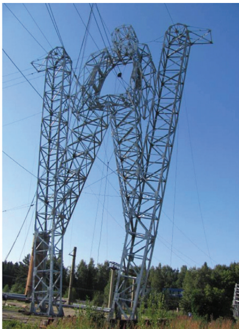
Рис. 6. Испытание единичного экземпляра металлической анкерно-угловой опоры УТР110-1 «Лыжник» для Олимпиады в г. Сочи в 2014 г.
