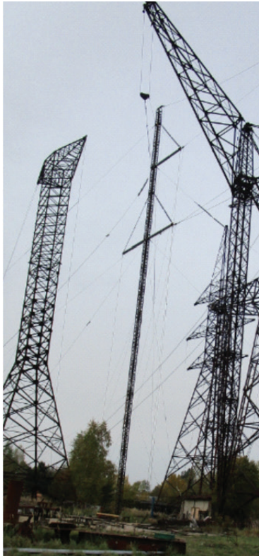
Рис. 5. Испытание быстромонтируемой промежуточной одноцепной опоры 330 кВ.
