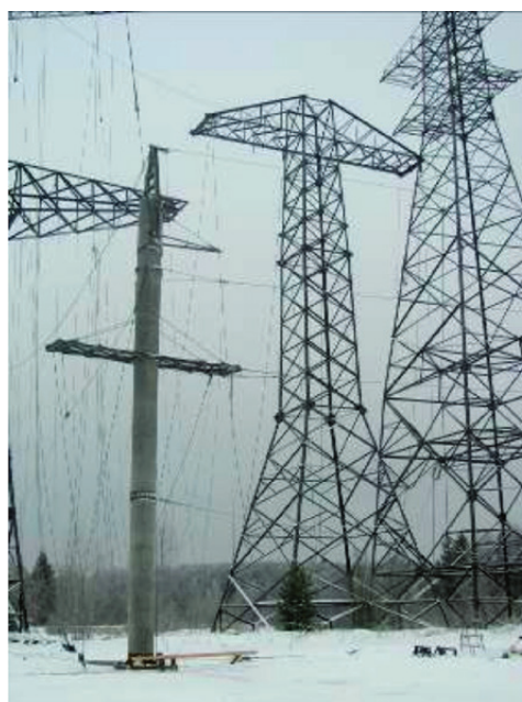
Рис. 15. Испытание одноцепной и двухцепной анкерно — угловых железобетонных секционированных опор СУБ110-1Ф и СУБ110-2Ф
