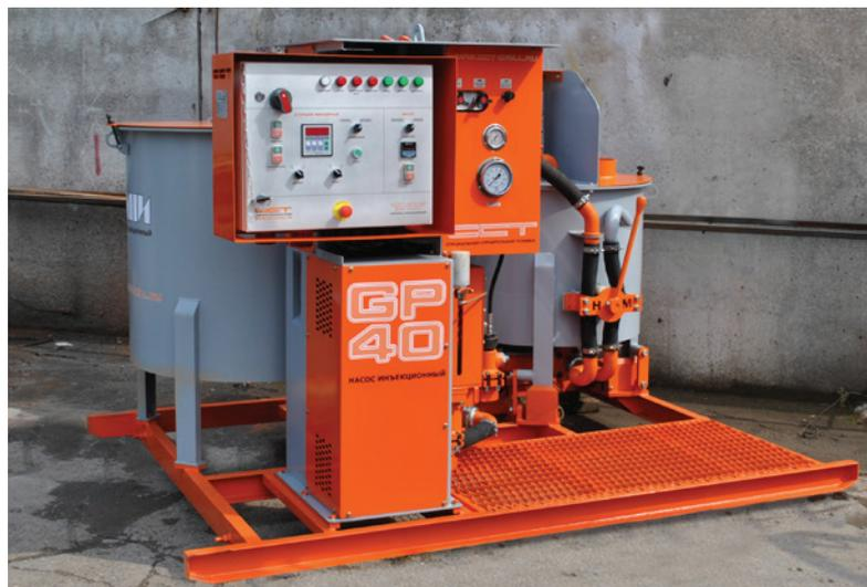
Рис. 5. Комплекс инъекционный MINI
