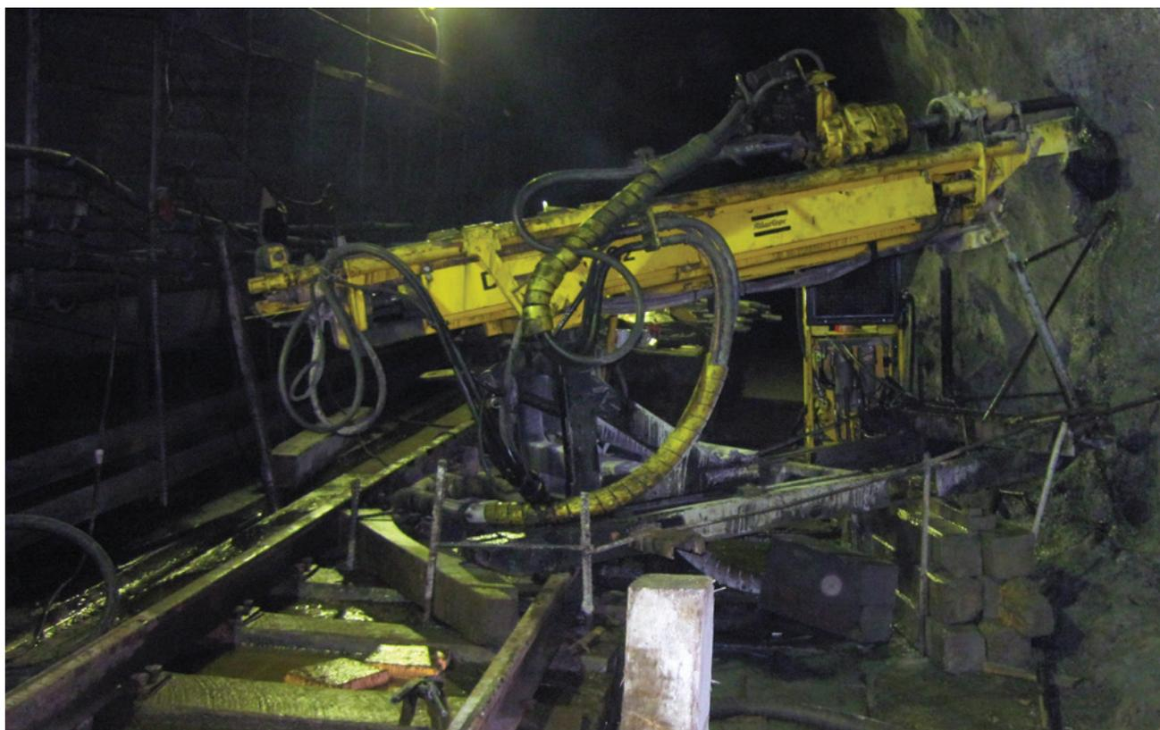
Рис. 2. Бурение скважин станком горизонтального бурения ДИАМЕК-262
