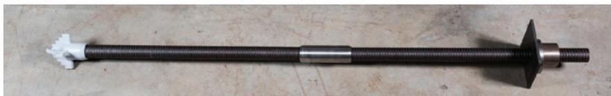
Рис. 1. Накатка винтовой поверхности
