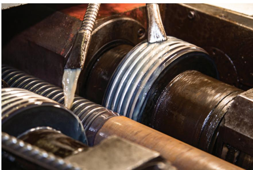
Рис. 2. Накатка винтовой поверхности
