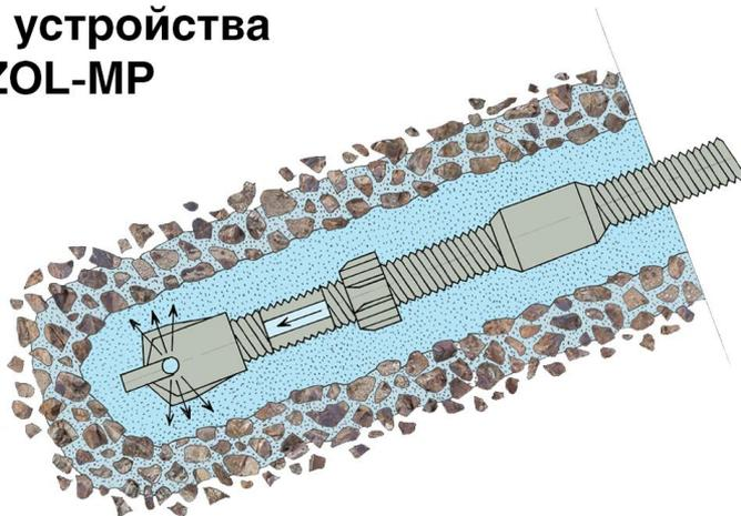
Бурение на проектную глубину с подачей бурового раствора
