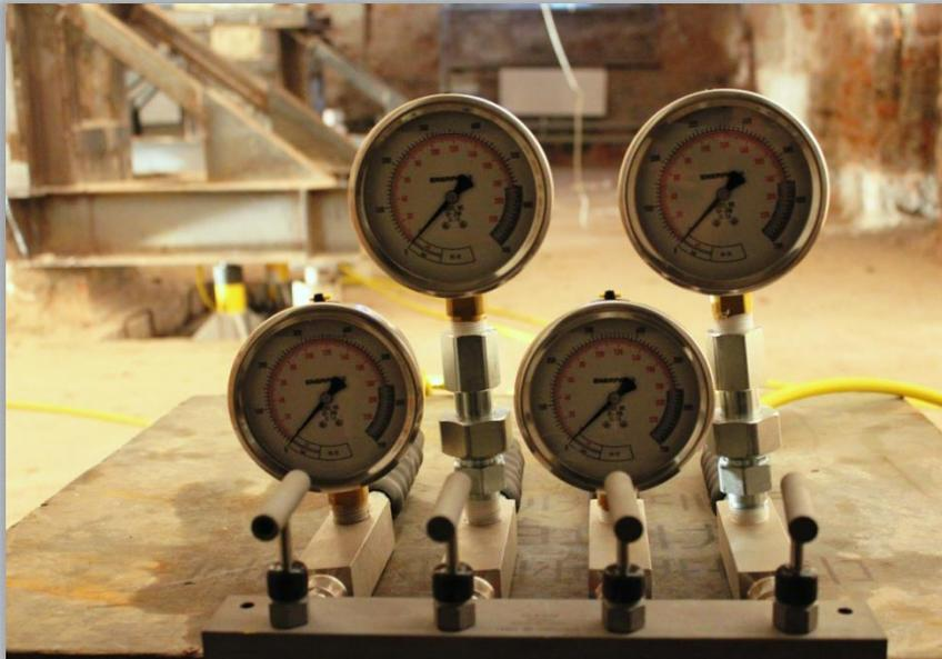
С помощью четырех гидравлических домкратов ENERPAC RC-256 на колонну поэтапно прикладывается суммарная расчетная нагрузка. Домкраты устанавливаются максимально близко к оголовку свай.
