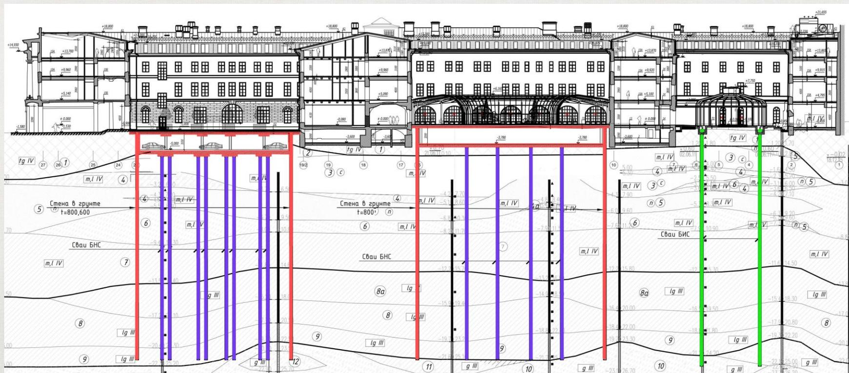
По внутреннему периметру дворов выполнена ограждающая конструкция из монолитного железобетона толщиной 600 (800) мм по технологии «стена в грунте» глубиной 26 м с плитным ростверком подземных этажей. Фундамент – свайный – из буронабивных свай (под защитой обсадных труб) диаметром 620 мм длиной 26 м.
